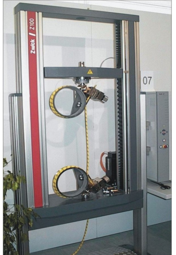
Sarmal (roller) çenelerle halat çekme testi
